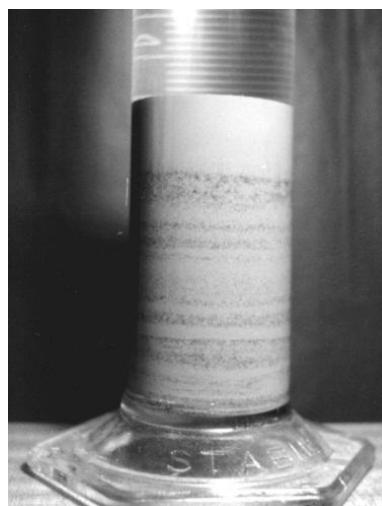
Figure 2 - Lamination résultant d'un écoulement à sec
